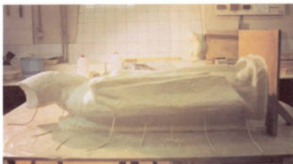
4. Estado final de la silicona mediante tornillos. La parte frontal quedaría registrada en una sola pieza, que a su vez haría la función de madre de las otras. Ésta pieza sería la base del molde y sobre ella apoyarían todas las laterales, también sujetas por tornillos (ver fotografías 5 y 6). Sobre las piezas laterales se practicaron unos taladros coincidentes con las cuerdas, para poder ser atadas en el exterior de la carcasa y asegurar, de este modo, que el molde no se descuelgue de la carcasa.
