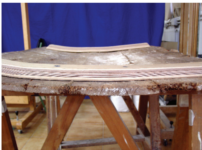
Fotos 11 y 12. En las zonas centrales de las tablas el travesaño queda separado unos milímetros con el fin de permitir eventuales movimientos de turgencia de la madera. Finalmente se colocan tornillos sin cabeza con el fin de cerrar el paso interno de las tuercas de navío.
