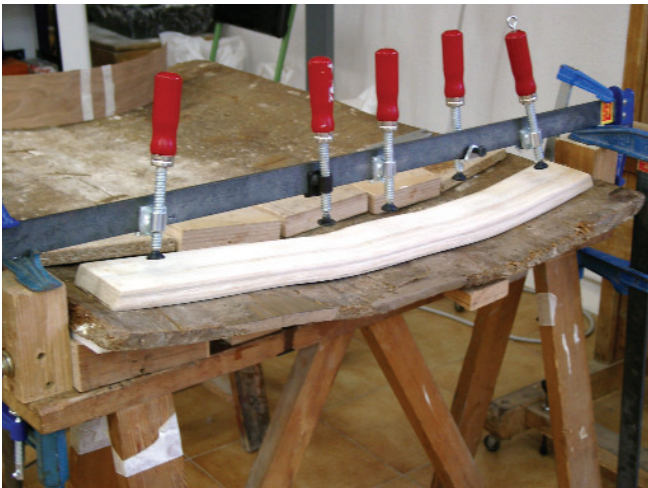
Fotos 5 y 6. Una vez obtenida la forma la fuerza antideslizante del adhesivo la mantiene de forma permanente. Biselado de los cantos mediante formón y cepillo de mano.
