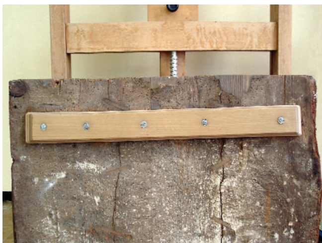
Fotos 11 y 12. En las zonas centrales de las tablas el travesaño queda separado unos milímetros con el fin de permitir eventuales movimientos de turgencia de la madera. Finalmente se colocan tornillos sin cabeza con el fin de cerrar el paso interno de las tuercas de navío.
