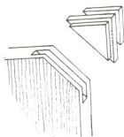
Esquema del injertado de las faltas de madera de una de las esquinas.
