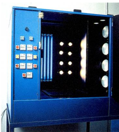
5. Ejemplo de la radiación aplicada a las muestras durante el ensayo.
