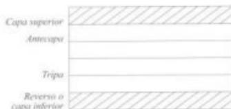
Fig. 1. Estructura de un cartón multicapa. (Basado en Smook, op. cit.)
