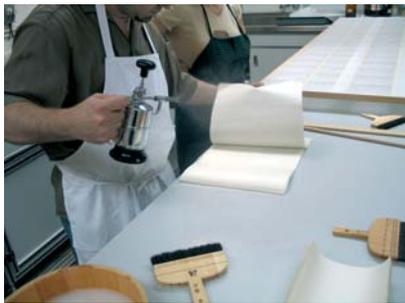
Se les aplica engrudo *diluido* por toda la superficie en forma de espiga, según dibujo y fotos, por el lado no satinado. Se emplea la brocha de pelo corto (SHIGOKE).
