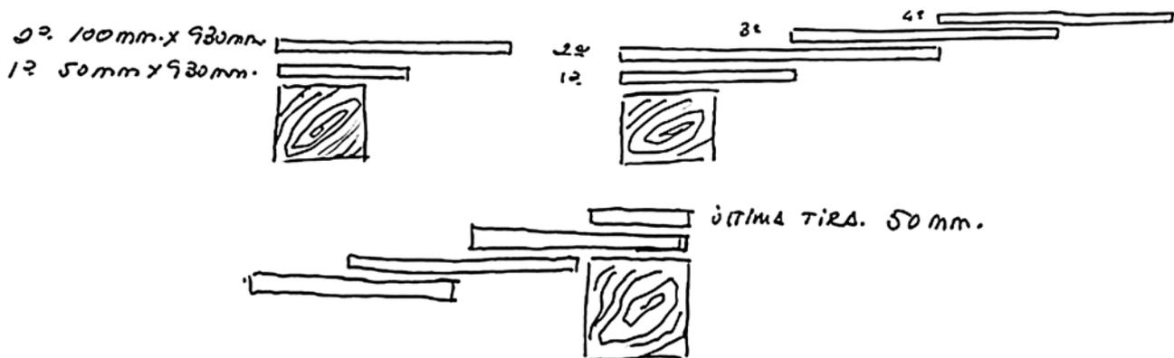
Es muy importante que las tiras no se coloquen con excesiva tensión. Se debe ir aplicando engrudo en los listones correspondientes repetidamente pues es normal que este se vaya secando durante la colocación de las tiras de papel. Una vez colocada cada tira conviene aplicarle por encima una ligera capa de engrudo, cuidadosamente para evitar desgarros y/o desplazamientos del papel.
