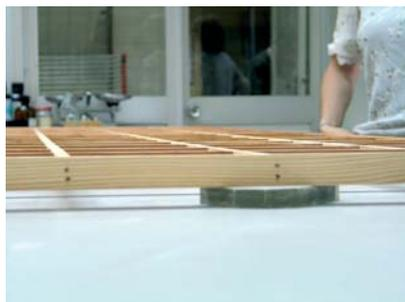
Se aplica engrudo *fuerte* en el borde del marco del bastidor y *diluido* en los travesaños interiores, con especial incidencia en las uniones de los mismos.
