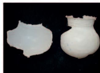
Lámina 16. Molde de silicona y modelo de escayola.
