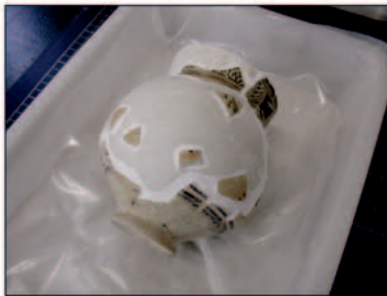
Lámina 34. Núcleos de resina acoplados.
